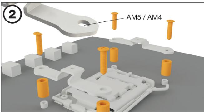
Placer les écrous-entretoises 4x AMD sur les boulons de la plaque arrière sur le côté avant et fixer les deux supports courts de montage AMD avec les vis pour la plaque arrière AMD.
