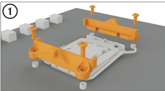
**Assemblage du cadre de montage du refroidisseur**
