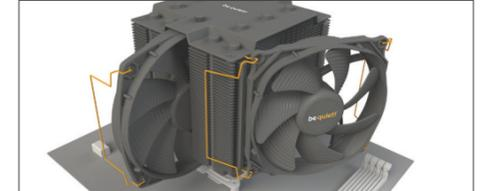
Lors du démontage des ventilateurs, repoussez les encoches des pinces de ventilateur (19) du ventilateur.
