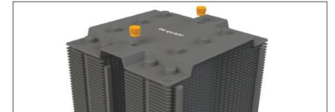
Positionnez le support de montage du refroidisseur (8) au centre du ventirad (1). Ensuite, placez l'unité de refroidissement sur le processeur. Insérer les vis de fixation du support de montage (13) par le haut dans le support de montage du refroidisseur (8), puis vissez les alternativement. Vous pouvez utiliser le tournevis cruciforme (17) pour cela.
