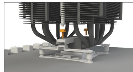
Fixez le ventilateur Silent Wings 3 120 mm (3) à l'aide des clips de fixation pour ventilateur (19) sur le côté avant du refroidisseur. Faites glisser le ventilateur 135 mm (2) entre les deux dissipateurs et fixez-le également avec des clips de fixation pour ventilateur (19). Connectez les deux ventilateurs à l'aide du câble Y (20). Branchez-le au connecteur du ventilateur du processeur sur la carte mère.
