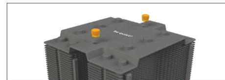
Positionnez le support de montage du refroidisseur (8) au centre du ventirad (1). Ensuite, placez l'unité de refroidissement sur le processeur. Insérer les vis de fixation du support de montage (13) par le haut dans le support de montage du refroidisseur (8), puis vissez les alternativement. Vous pouvez utiliser le tournevis cruciforme (17) pour cela.
