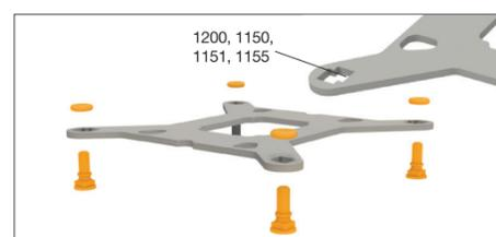
Pour fixer les vis de la plaque arrière sur la plaque arrière Intel (4), utilisez les joints toriques (16). Une fois l'assemblage de la plaque arrière Intel pour le socket Intel terminé, placez-le sous la carte mère. Ce faisant, assurez-vous que les vis de la plaque arrière Intel (14) sont positionnées avec précision dans les trous de la carte mère.
