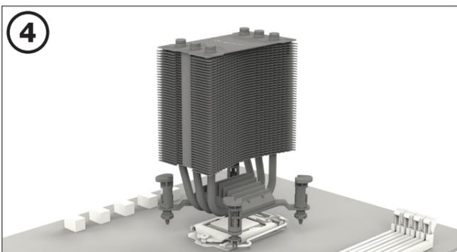
Coloque la unidad de refrigeración sobre la CPU.
