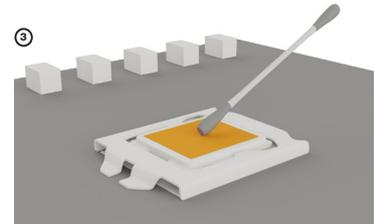
3 Extienda la pasta térmica de metal líquido con los bastoncillos. A continuación, instale el refrigerador.
