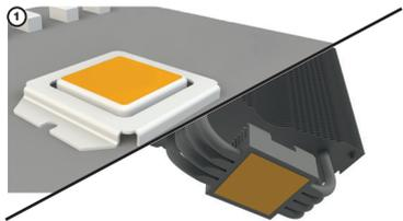
1 Limpie la superficie del refrigerador y de la CPU con la almohadilla impregnada con alcohol antes de aplicar la pasta térmica. La superficie debe estar seca y libre de suciedad.
