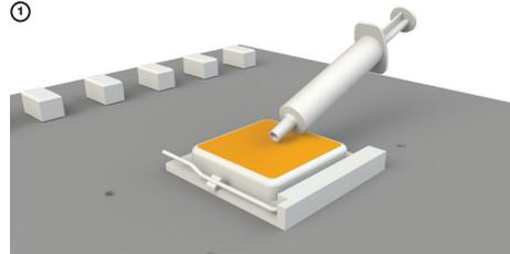
La cubierta protectora de la debajo del refrigerador debe ser quitarla. Aplique pasta térmica en la superficie de la CPU.
