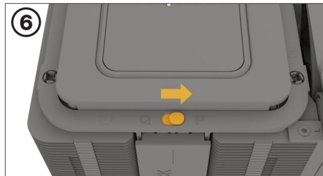
Dark Rock Elite tiene un modo silencioso (Q) y un modo de Rendimiento (P). El modo afecta a las velocidades máximas del ventilador y el ruido de funcionamiento. Para cambiar de modo, retire primero el marco magnético superior. Mueva el interruptor para cambiar de modo.
