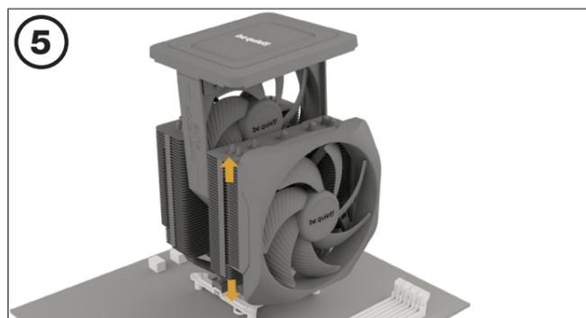
Centre el ventilador Silent Wings de 135 mm desde arriba. A continuación, deslícelo en el hueco entre los disipadores y presiónelo firmemente. Conecte ambos ventiladores mediante el cable en Y. Puede ajustar la altura del ventilador frontal Silent Wings de 135 mm empujándolo de arriba a abajo.
