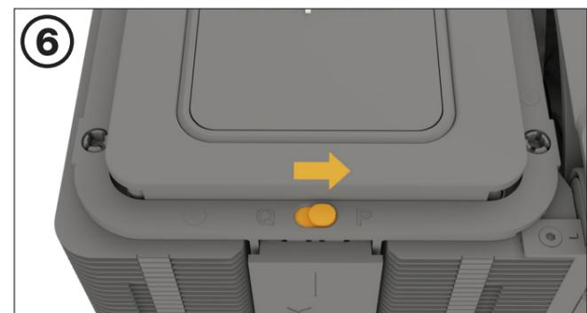
Dark Rock Elite tiene un modo silencioso (Q) y un modo de Rendimiento (P). El modo afecta a las velocidades máximas del ventilador y el ruido de funcionamiento. Para cambiar de modo, retire primero el marco magnético superior. Mueva el interruptor para cambiar de modo.
