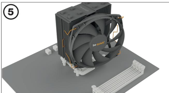
Закрепите 135мм вентилятор на радиаторе кулера используя клипсы для вентилятора. Подключите вентилятор к PWM разъему на материнской плате.
