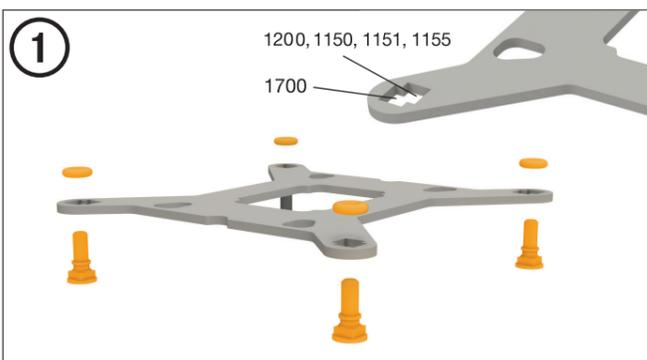
**Монтаж задней пластины**
