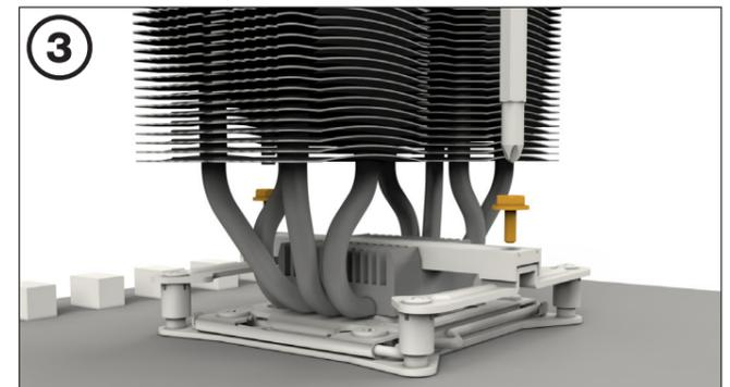
Расположите крепежный мост кулера по центру кулера. Затем установите кулер на процессор. Вставьте винты крепежного моста сверху в крепежный мост кулера и затяните их попеременно. Используйте для этого отвертку с крестообразным шлицом.
