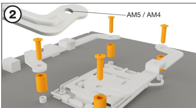
Нажмите 4 распорные гайки AMD на выступающие через переднюю часть материнской платы болты задней панели и закрепите длинные кронштейны AMD винтами задней пластины AMD.
