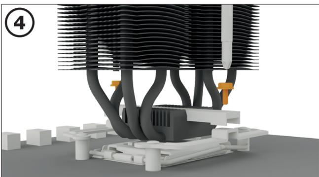
Расположите крепежный мост кулера по центру кулера. Затем установите кулер на процессор. Вставьте винты крепежного моста сверху в крепежный мост кулера и затяните их попеременно. Используйте для этого отвертку с крестообразным шлицом.
