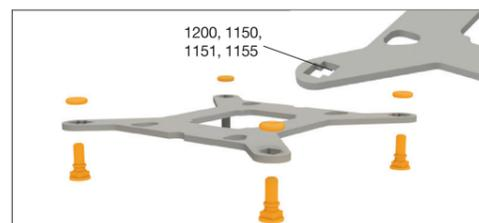
Verwenden Sie zur Befestigung der Backplate-Schrauben auf der Intel-Backplate die O-Ringe. Sobald die Intel-Backplate für den jeweiligen Intel-Sockel zusammengebaut ist, positionieren Sie es unter dem Mainboard. Achten Sie dabei darauf, dass die Intel Backplate-Schrauben genau in den Mainboardlöchern positioniert sind.
