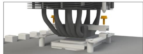
Legen Sie die Kühler-Montagebrücke mittig auf den Kühler. Anschließend platzieren Sie den Kühler auf der CPU. Stecken Sie die Befestigungsschrauben der Kühler Montagebrücke von oben auf die Kühler-Montagebrücke und schrauben Sie diese abwechselnd fest. Hierzu können Sie den Kreuzschraubendreher benutzen.
