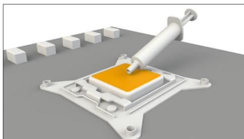
Legen Sie die Kühler-Montagebrücke mittig auf den Kühler. Anschließend platzieren Sie den Kühler auf der CPU. Stecken Sie die Befestigungsschrauben der Kühler Montagebrücke von oben auf die Kühler-Montagebrücke und schrauben Sie diese abwechselnd fest. Hierzu können Sie den Kreuzschraubendreher benutzen.
