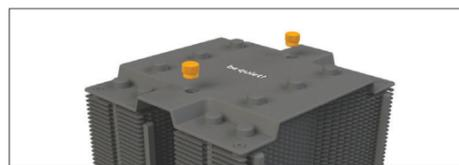
將散熱器安裝橋接處 (8) 置於散熱器 (1) 中央。接著,將散熱器放置於 CPU 上方。鬆開位於散熱器頂端中央的兩個熱管蓋 (如圖所示旋轉)。將 Intel/AMD 安裝橋接處固定螺絲 (13) 由上往下插入散熱器安裝橋接處 (8),然後用螺絲交替鎖緊。您可使用十字型螺絲起子 (17) 執行此操作。
