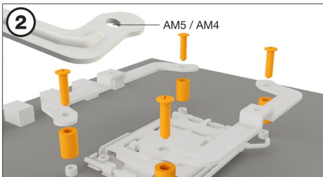
Наживите 4 распорные гайки AMD на выступающие через переднюю часть материнской платы болты задней панели и закрепите длинные AMD кронштейны винтами задней пластины AMD.
