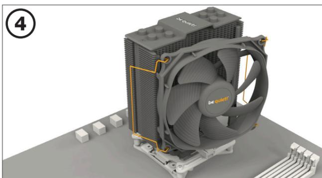
Установите 120мм вентилятор на кулер, используя клипсы для вентилятора. Подключите вентилятор к PWM разьему на материнской плате.
