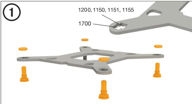
**Монтаж задней пластины**
