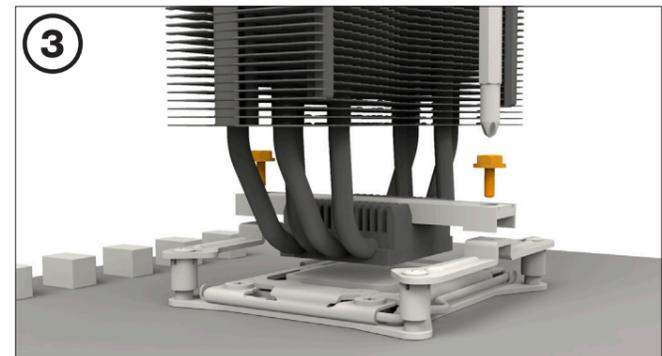
Расположите крепежный мост для кулера по центру кулера. Затем установите кулер на процессор. Вставьте винты крепежного моста Intel/AMD сверху в крепежный мост для кулера и затяните их попеременно. Используйте для этого крестовую отвертку.
