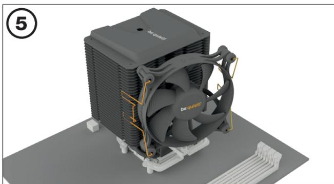
Fije el ventilador de 120 mm en la unidad de refrigeración utilizando clips de ventilador. Conecte el ventilador a la señal PWM de la placa base.
