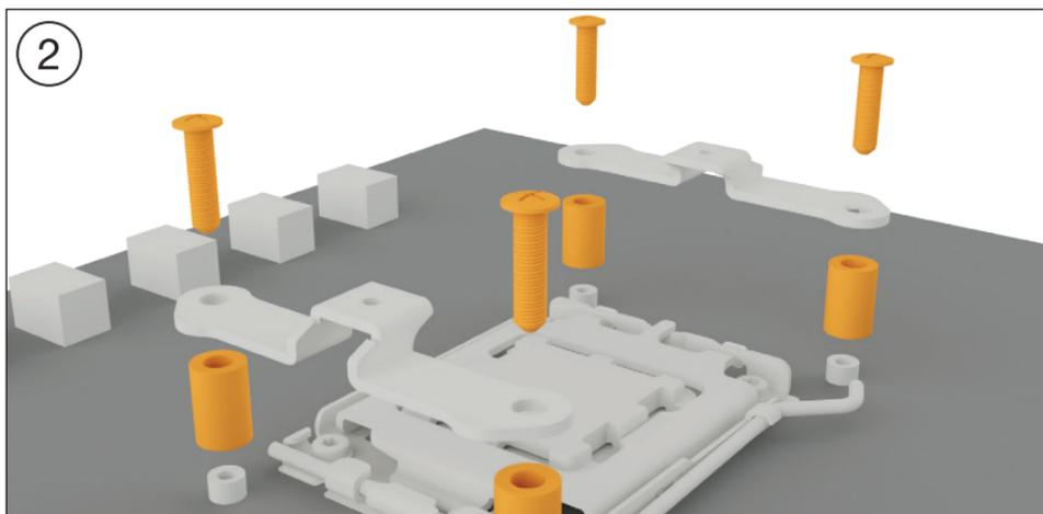
Placez les quatre boulons d'écartement AMD sur les filetages de la plaque arrière, sur la façade avant, et fixez les deux ponts de montage AMD à l'aide des vis de la plaque arrière AMD.
