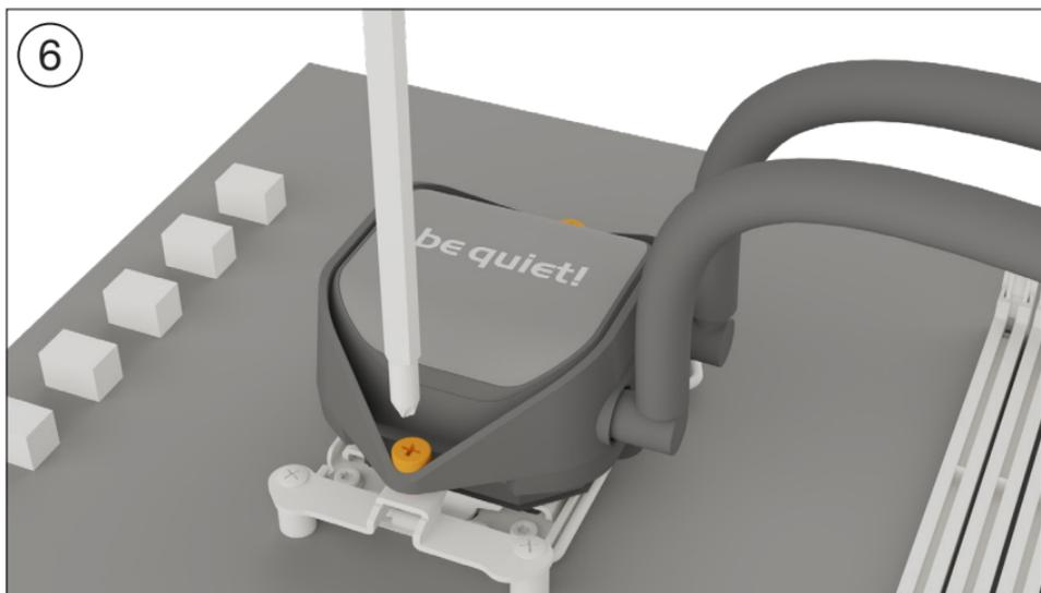
Placez le bloc processeur au centre des supports de fixation de montage Intel de manière à ce que le bloc processeur puisse être vissé à ces derniers. Pour ce faire, vous pouvez utiliser un tournevis cruciforme classique.
