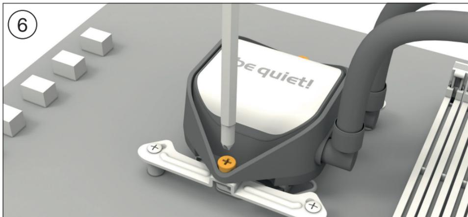
Placez le bloc processeur au centre des supports de fixation de montage Intel de manière à ce que le bloc processeur puisse être vissé à ces derniers. Pour ce faire, vous pouvez utiliser un tournevis cruciforme classique.
