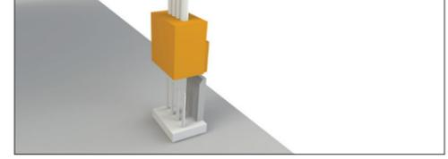
Positionnez le radiateur de telle sorte que les ventilateurs soient à l'horizontale et fixez le à l'aide des vis M3x16 (9)
