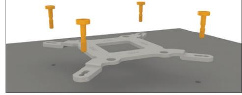
Fixez la plaque arrière sur la face avant de la carte mère en utilisant les entretoises-C (12), poussez celles-ci sur les vis M3x16 (9) jusqu'à ce qu'elles se clipsent.
