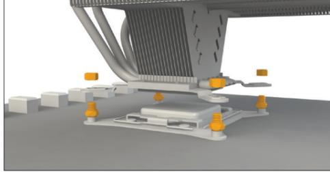
Placez les écrous hexagonaux (8) sur les écrous entretoises (7) et progressivement resserrer les en croix au maximum à l'aide de la clé hexagonale (14).
