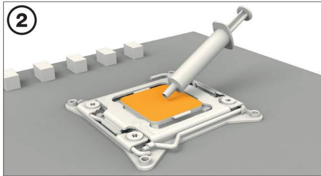
**安裝 CPU 散熱器**
