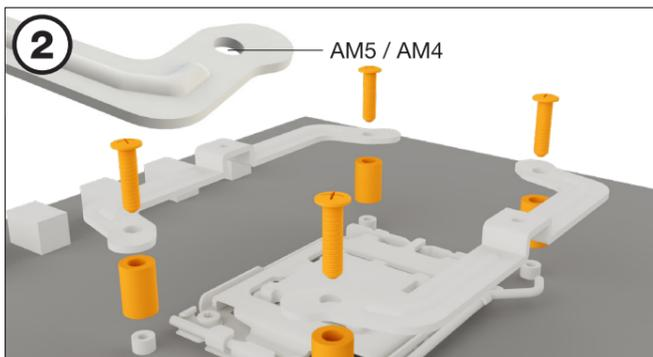
將四個 AMD 間隔螺帽 置於穿過前側的背板螺絲上，並使用 AMD 背板螺絲 固定 兩個 AMD 長型安裝托架。
