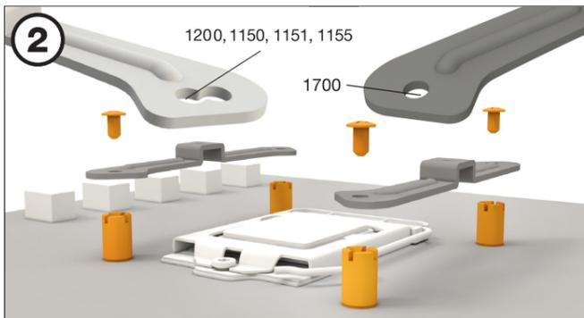
**安裝托架的安裝方法**
