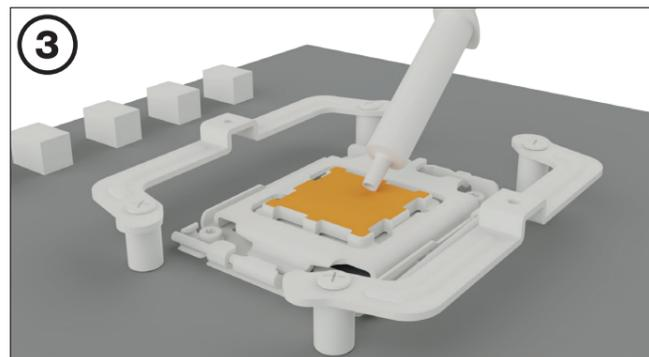
**安裝 CPU 散熱器:**
