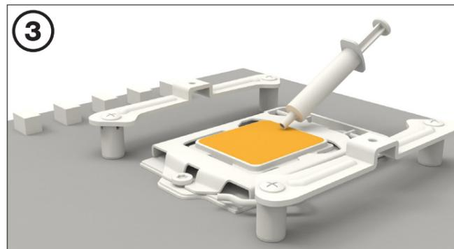
**安裝 CPU 散熱器**
