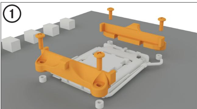
**散熱器安裝框架的組裝方法**
