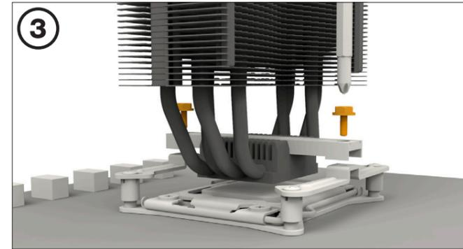
將散熱器安裝橋接處 置於散熱器中央。接著，將散熱器 放置於 CPU 上方。將 Intel/AMD 安裝橋接處固定螺絲 由上往下插入散熱器安裝橋接處，然後用螺絲交替鎖緊。您可以在此操作上使用任何的十字型螺絲起子。
