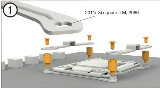
**散熱器安裝框架的組裝方法**
