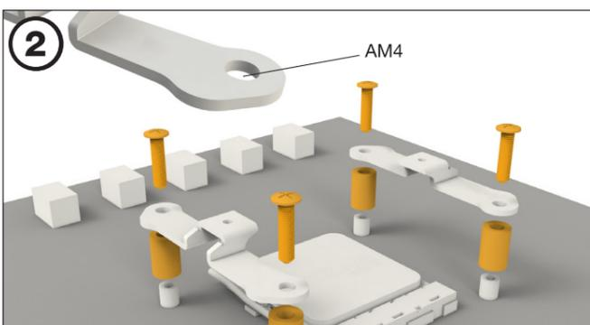
將四個AMD垫片螺母 (10) 拧在从主板前端露出的背板螺柱上，然後使用AMD背板螺釘 (13) 固定兩副AMD長安裝支架 (7)。
