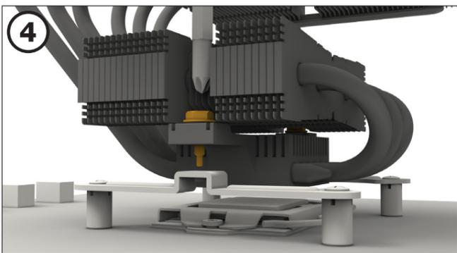
將散熱器放置於CPU處理器上，並將安裝橋確實鎖緊。
