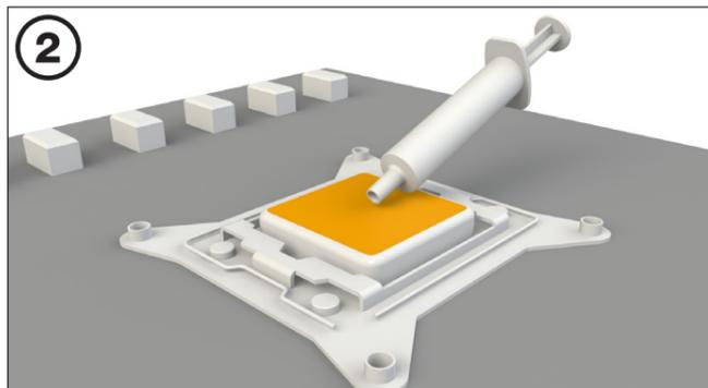
**安裝 CPU 散熱器**
