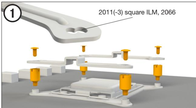
**散熱器安裝框架的組裝方法**
