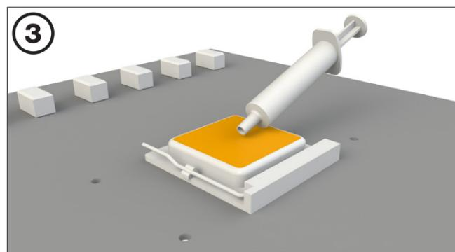
**安裝 CPU 散熱器**
