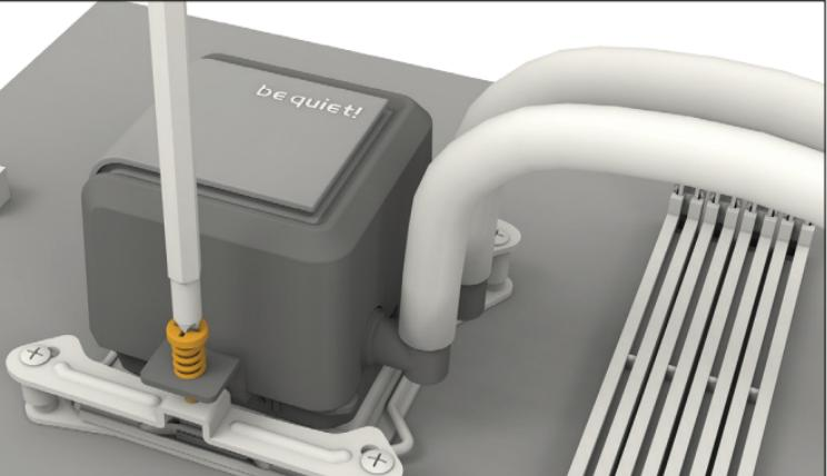
Разместите блок охлаждения процессора по центру над монтажными кронштейнами Intel (4) и закрепите его. Для этого вы можете использовать обычную крестовую отвертку.
