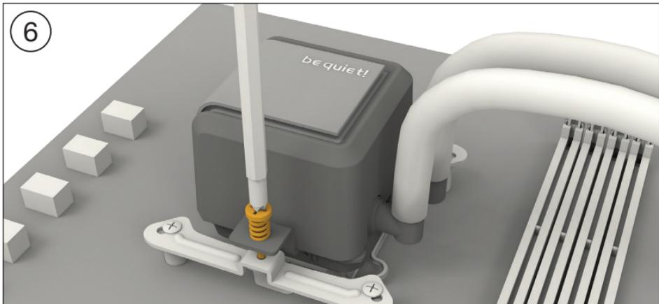
Разместите блок охлаждения процессора по центру над монтажными кронштейнами Intel (4) и закрепите его. Для этого вы можете использовать обычную крестовую отвертку. Далее подключите помпу к материнской плате.
