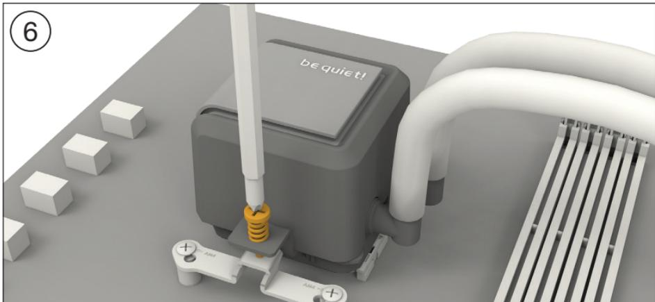
Разместите блок охлаждения процессора по центру над монтажными кронштейнами AMD (5) и закрепите его. Для этого вы можете использовать обычную крестовую отвертку. Далее подключите помпу к материнской плате.
