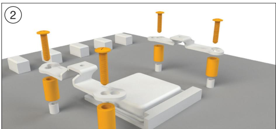
Установите четыре Проставки AMD (8) на выступающие через переднюю часть материнской платы болты задней панели и закрепите короткие монтажные кронштейны AMD (5) винтами задней пластины AMD (11).
