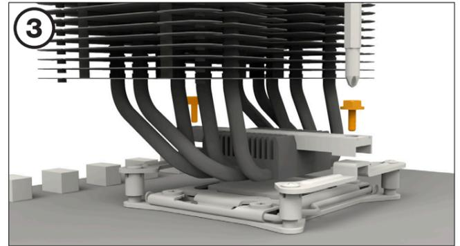
Positionnez le pont de fixation du refroidisseur au centre du ventirad. Ensuite, placez l'unité de refroidissement sur le processeur. Insérez les vis de fixation du pont de montage Intel par le haut dans le pont de montage du refroidisseur, puis vissez les alternativement au maximum.
