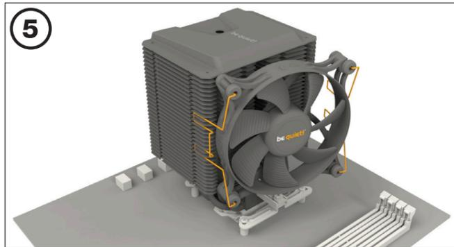
Fixez le ventilateur de 120 mm sur l'unité de refroidissement à l'aide des clips de fixation pour ventilateur. Connectez le ventilateur au signal PWM de la carte mère.
