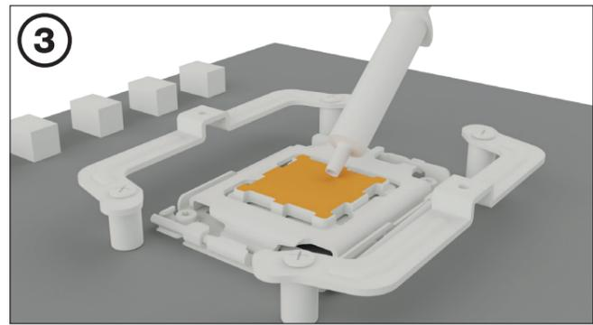
**安裝CPU散熱器**
