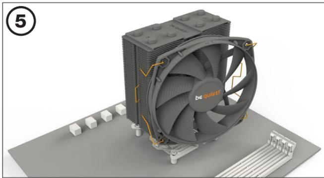
使用風扇扣具 將 135mm 風扇 固定至散熱器。將風扇連接到主機板的 PWM 訊號。
