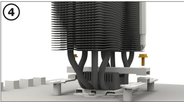
將散熱器安裝橋接處 置於散熱器中央。接著，將散熱器 放置於 CPU 上方。將安 裝橋接 處固定螺絲 由上往下插入散熱器安裝橋接處，然後用螺絲交替鎖緊。
