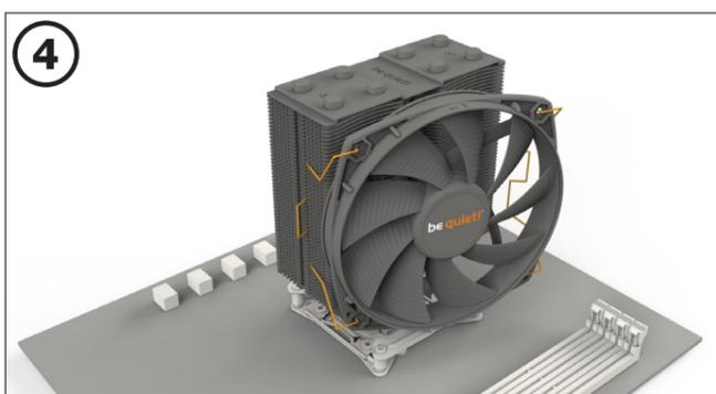
使用風扇扣具 將 120mm 風扇 固定至散熱器。將風扇連接到主機板的 PWM 訊號。
