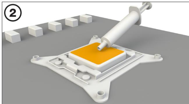
**安裝 CPU 散熱器**
