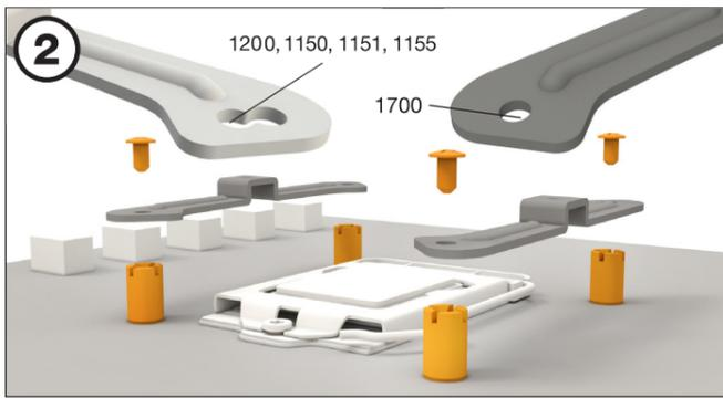
**安裝托架的安裝方法**
