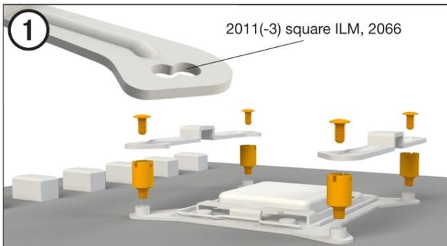
**散熱器安裝框架的組裝方法**
