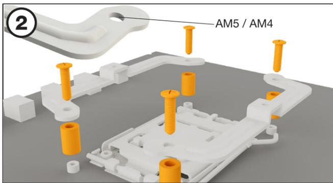
將四個AMD墊片螺母拧在從主板前端露出的背板螺絲上，然後使用AMD背板螺釘 固定 兩副AMD長安裝支架。
