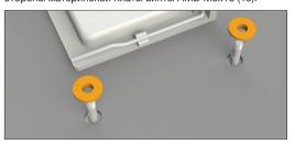
Используя С-образные шайбы (12), зафиксируйте заднюю пластину с лицевой стороны материнской платы, защелкнув шайбы прорезями к винтам AMD M3x15 (10).
