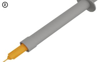
② Навинтите наконечник на шприц с термопастой. Аккуратно выдавите небольшую каплю термопасты на основе жидкого металла.
