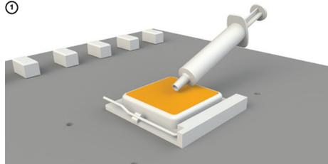
Снимите защитное покрытие с нижней части кулера. Нанесите термопасту на поверхность процессора.
