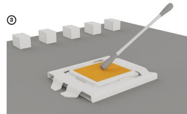
③ Равномерно распределите каплю термопасты на основе жидкого металла по поверхности процессора с помощью ватных палочек. Далее установите систему охлаждения.
