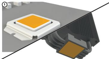
① Очистите и обезжирьте влажной салфеткой поверхность кулера и процессора, прежде чем наносить термопасту. Поверхность должна быть сухой и чистой.
