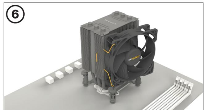
使用風扇夾 以將92mm風扇 固定至散熱器上, 並將風扇連接至主機板上的PWM 訊號針腳上。
