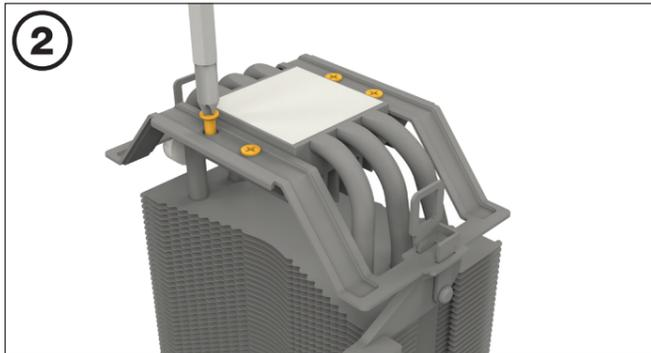
**安裝 CPU 散熱器**
