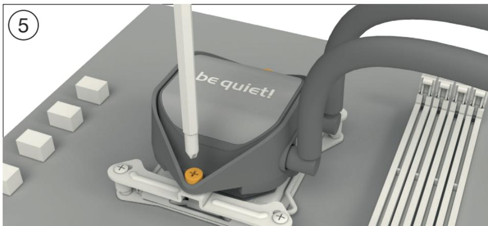
Coloque el bloque de CPU en una posición central sobre los puentes de montaje Intel, de forma que permitan desatornillar el bloque de CPU. Para ello, puede usar un destornillador de estrella convencional. A continuación, conecte la bomba y la iluminación LED al adaptador SATA.
