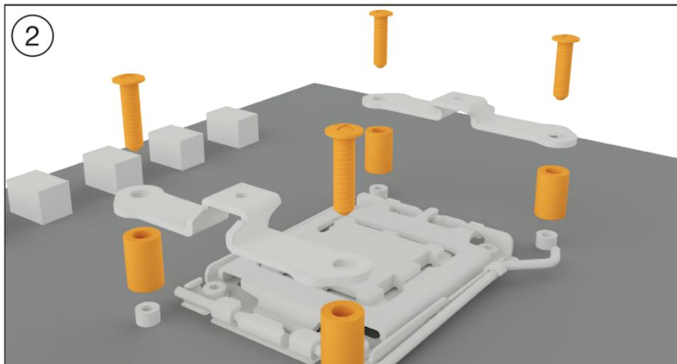
Coloque los cuatro pernos espaciadores AMD (9) sobre las roscas de la placa posterior en el frontal y fije los dos puentes de montaje AMD (6) con los tornillos para placa posterior AMD (12).
