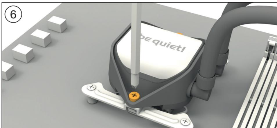
Coloque el bloque de la CPU centrado sobre los soportes de montaje Intel o los soportes de montaje Intel LGA 1700, de manera que éstos permitan atornillar el bloque de la CPU. Para ello puede utilizar un destornillador de estrella normal. A continuación, conecte la bomba y la iluminación LED con el adaptador SATA.
