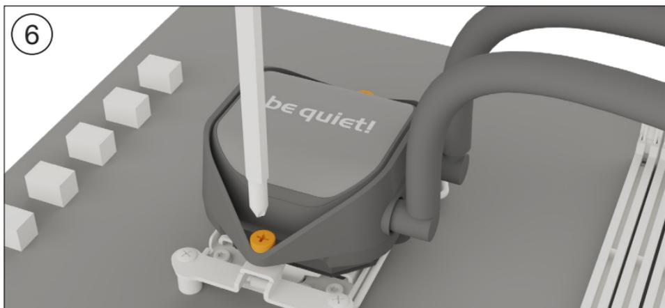
Coloque el bloque de CPU en una posición central sobre los soportes de montaje AMD cortos, de forma que permitan desatornillar el bloque de CPU. Para ello, puede usar un destornillador de estrella convencional. A continuación, conecte la bomba y la iluminación LED al adaptador SATA (18).
